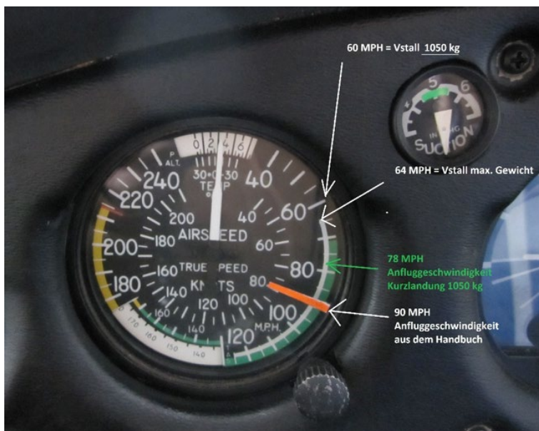
Airspeed-Indicator meiner Piper Arrow. Man beachte den deutlichen Unterschied zwischen der Handbuch-Anfluggeschwindigkeit (90 MPH) und der tatsächlich für eine Kurzlandung verwendeten Geschwindigkeit (78 MPH).
